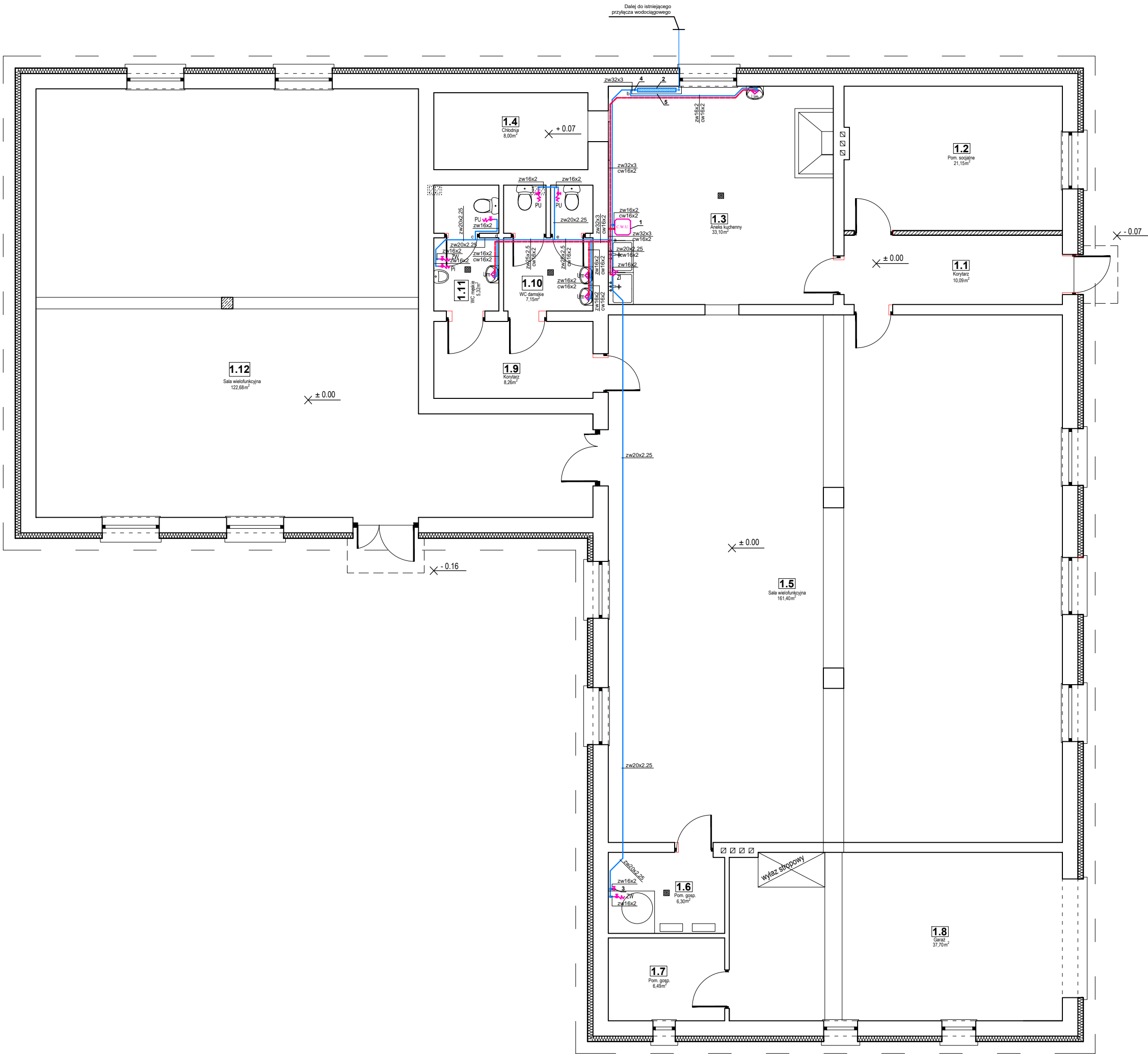
Schemat węzła wodomierzowego zlokalizowanego w pom. 1.3 (aneks kuchenny)
